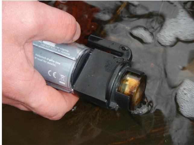
Figure 4 : Photographie de la récupération de données grâce à la navette étanche
